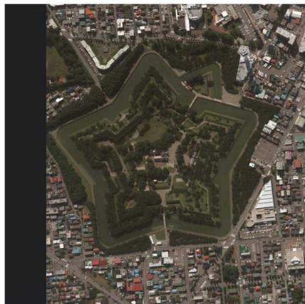
L'utilisation des armes à feu a entraîné un tournant radical dans les tactiques de guerre en Occident. En effet, les hautes murailles datant du Moyen Âge étaient vulnérables aux assauts. Afin de réduire leur hauteur et donc ces zones fragiles, des fortifications en forme d'étoile ou de pentagone ont été érigées, avec tourelles et soldats postés aux cinq coins dans des bastions.
